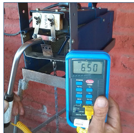
高温计显示刀片温度为650°C。
